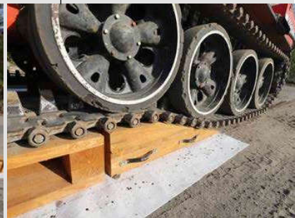
Λεπτομέρεια ερπυστριοφόρου οχήματος να ανεβένει στην ξύλινη ράμπα
