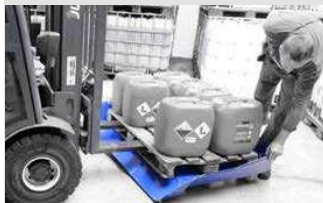
Οι γωνίες δεν είναι σφραγισμένες και έτσι ο μουςαμάς μπορεί εύκολα να διπλωθεί γύρω από την παλέτα
